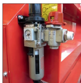
Zawór pneumatyczny Lock-Out (Tylko modele zasilane pneumatycznie)
