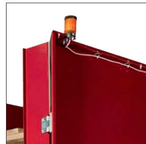
Sygnalizacja świetlna z czujnikiem pełnego stosu
