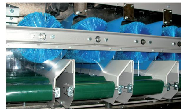
Cepillos rotativos para amortiguar la caída del producto sobre las cintas de salida.
