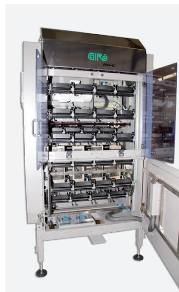
La parte frontal de la **PDG-4** se abre completamente para permitir el acceso a las barras de cubetas, facilitando su limpieza y mantenimiento. Una amplia puerta, junto con el panel de control pivotante, ofrece acceso a 24 cubetas.
